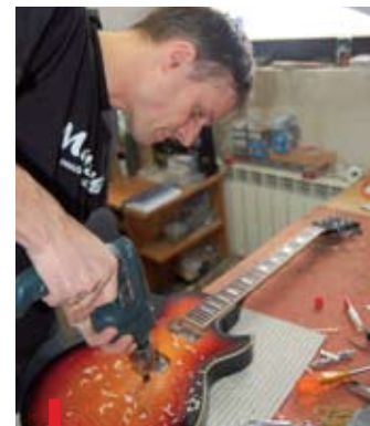
Marcin Kaleta z wielką precyzją przygotowuje w instrumente „mostek” na założenie strun
